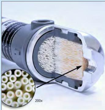
典型的膜分离器含有数千根纤维，两端用环氧树脂浇铸密封。纤维束端部被切除，使其两端露出纤维孔，以让气体从一端移动到另一端。纤维束封闭在一个合适的壳体中。该壳体用于保护纤维，并引导气体正确流动。
